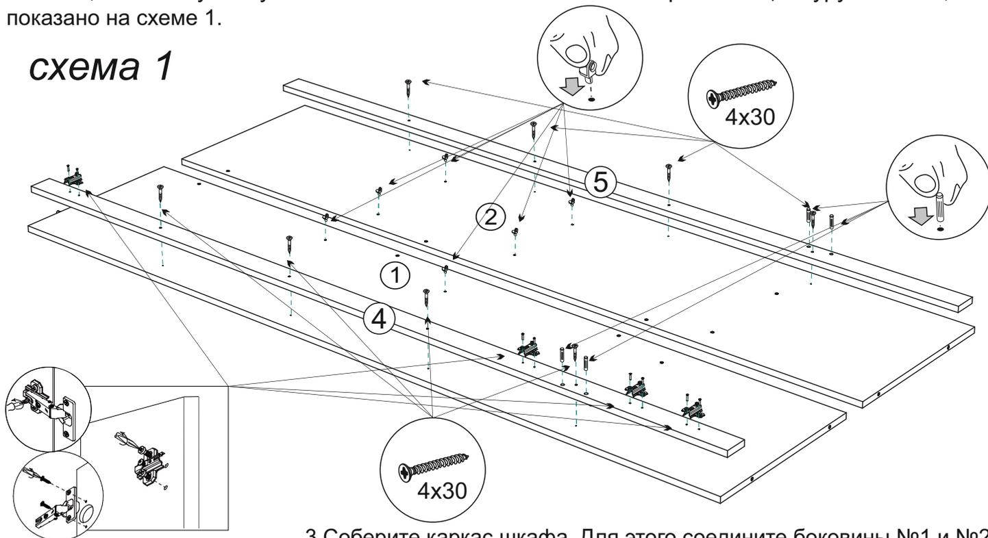
3. Соберите каркас шкафа. Для этого соедините боковины №1 и №2 евроинтами с задней стенкой №3 и вязкой №8, панель 3Д №16 установите на шканы. Затем евроинтами прикрепите крышки №6 и №7 а планки №9 прикрутите шурупами 4x30 по наметкам к крышкам. Прикрутите опору шурупами 4x25, как показано на схеме 2.
